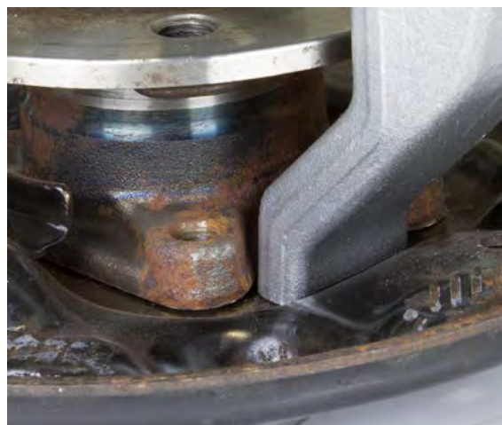
Puristusjalka pääsee pienellekin pinnalle lähelle laakeria, puristaen vartta jarrukilven takaa.
