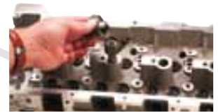
600 122 Injektorenzuziehler DB CDI Motoren Injector puller DB CDI motors
