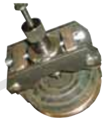
Abzieher Schwingungsdämpfer Extraction of vibration dampers
