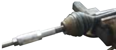
537 710 Antriebswellen-Trenner M16x1,5 Drive shaft separator M16x1.5
