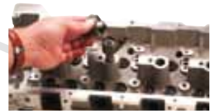
600 122 Injektorenschieber DB CDI Motoren Injector puller DB CDI motors
