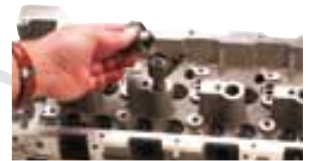
600 122 Injektorenzug DB CDI Motoren Injector puller DB CDI motors
