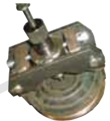
Abzieher Schwingungsdämpfer Extraction of vibration dampers
