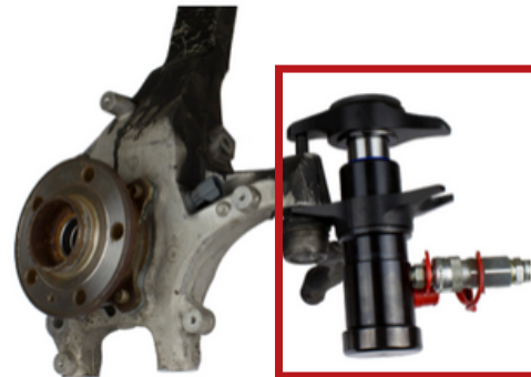
Pallonivelten irrotustyökalu myös raidetangonpään irrotukseen 04-00024
