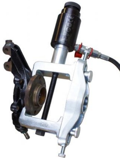
Irrotusjalkojen 01-00037-020 paikalleen puristaminen
